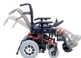
Basculante y reclinable. Rango de reclinación de 0° a 30° y basculante de 0° a 10°.
