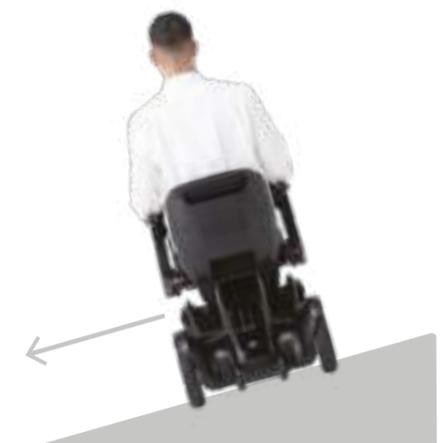
La WHILL Model C2 está diseñada para evitar la deriva. Mantiene la conducción recta incluso en terrenos con inclinación lateral.
