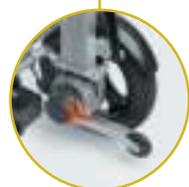
Motor de 24V x 250W (sin escobillas). Ruedas antivuelco.
