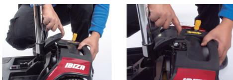
**Baje el mástil en la sección frontal.** Gire la perilla de ajuste del mástil para aflojar y luego baje el mástil. Gire el mástil ligeramente para que se pliegue sin golpear el poste del asiento.
