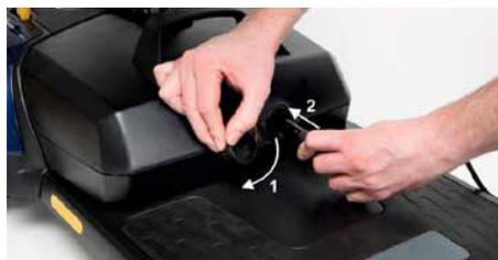
La batería se puede cargar a bordo del scooter (como se muestra en la imagen anterior). Alternativamente, la batería se puede extraer del scooter y la batería se puede cargar lejos de la scooter.
