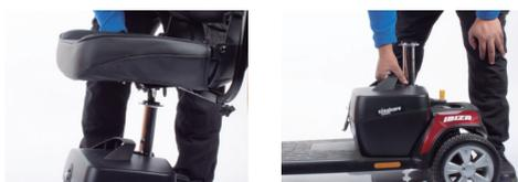
**Separe las secciones delantera y trasera.** Presione hacia abajo la manija de la sección trasera (1) mientras tira hacia arriba usando la palanca (2) en la sección delantera.
